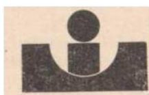
Рис. 1. Схема прицеливания при открытом прицеле
